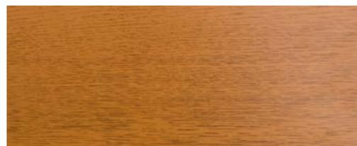
40 µm dicker Polyesterlack mit Zinküberzug Z275 oder Zink-Magnesium ZM120. Es zeichnet sich aus durch Holzstruktur und ausreichenden Schutz gegen Korrosion und UV-Strahlung. Diese Kombination ermöglicht Einsatz im Außenbereich, insbesondere dort, wo hohe Witterungsbeständigkeit und hohe Ästhetik gefordert sind.
